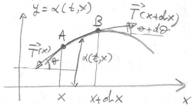
Proviamo ora di spiegare schematicamente una corda tesa. Consideriamo una corda sotto tensione uniforme, eseguiamo il suo  $x$  parallelo alla configurazione riflettendo che la corda curva è sottoposta in virtù della tensione  $T$  ad essere aperta (trascurando l'effetto delle forze perpendicolari). Se dunque  $\lambda = \frac{\partial w}{\partial x}$  la densità lineare della corda -
