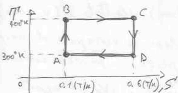
Nella trasformazione isoterma:  $Q = -L = nRT \ln \frac{V_f}{V_i}$
